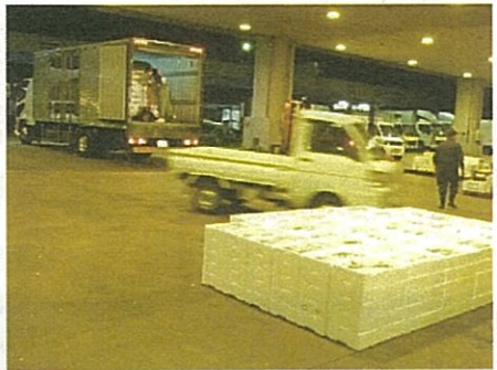
荷さばき所陸側は開放型 鳥獣の進入、外部からそのまま人の入場 荷さばき所内に車両進入
