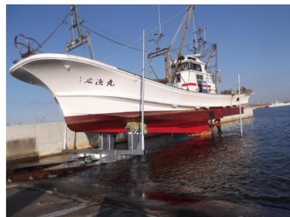
(他地区参考写真) 漁船を載せた上架中の台車
