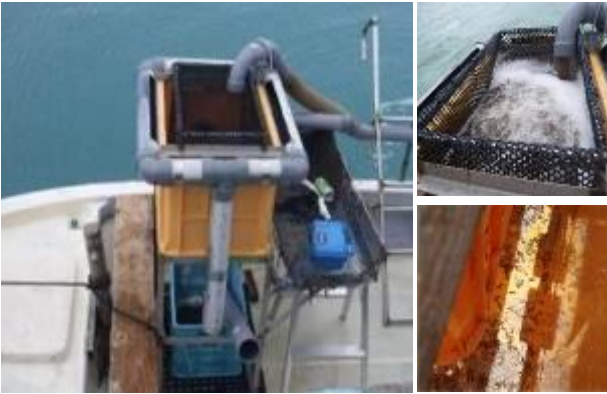
図5 普及されたモズク収穫時における 異物選別機
