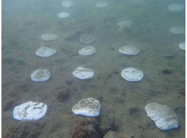
図8 紙粘土設置（坊泊漁港：覆砂前）
