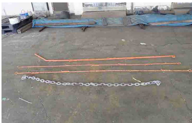
写真2. 掃海道具（上から太鉄筋、細鉄筋×2、チェーン）
