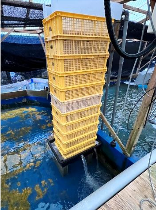
図1 コンテナによる曝気装置 (右奥は曝気槽)
