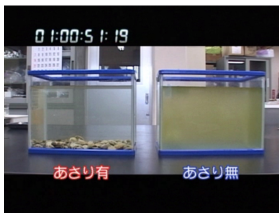
図 1.2.1 アサリによる水質浄化(アサリを入れた水槽は1時間後に透明に)
