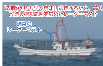
レーダーマストを高く改造した外国漁船
