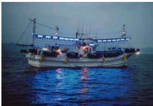
発光ダイオードを使用したイカ釣り漁船の実証実験
