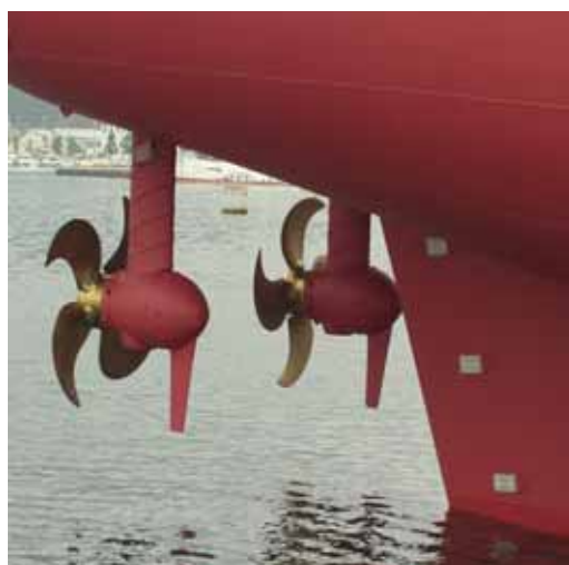
電気推進システムを利用した漁船（プロペラ軸・舵がなく 船尾がスリム化されている。）
