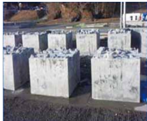
図2. コンクリートがらを使用して試作したブロック
