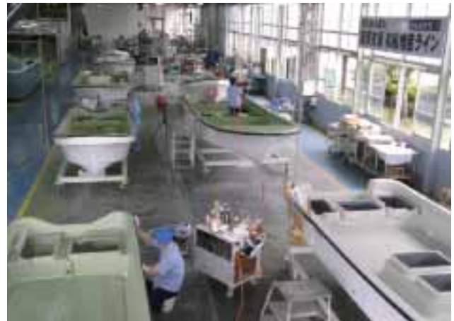
国内造船所における新造漁船の和船造船ライン
