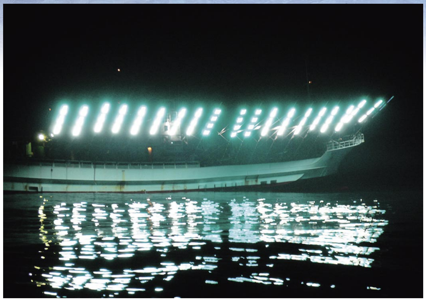
LED集魚灯を搭載した大型さんま漁船
