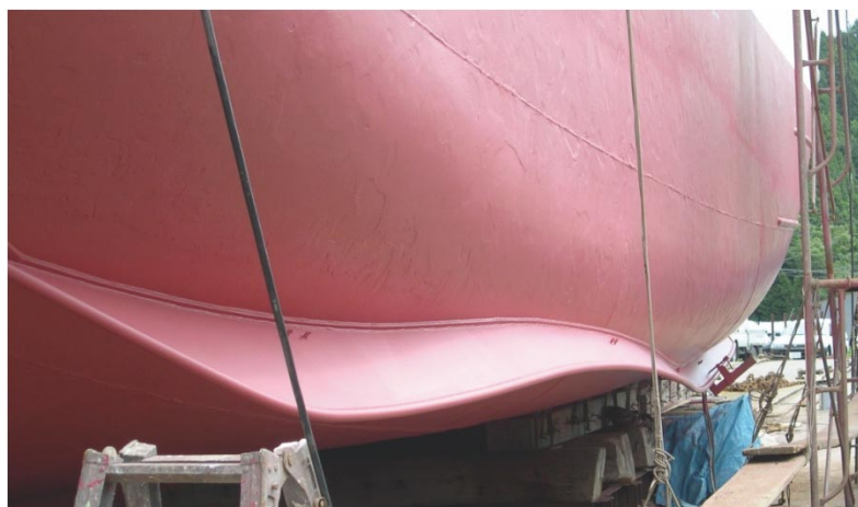
上図：船体表面の流れの可視化 下図：流れに沿ったビルジキール
