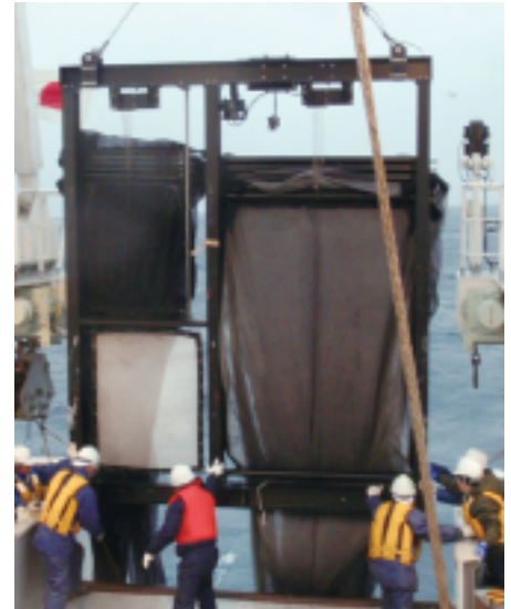
写真2 1m 2 +4m 2 ハイブリット式環境センサー付き多段開閉ネット
