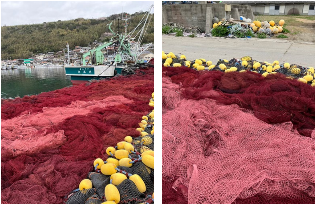
図3-15 テトロン製リサイクル漁網を取り付けた中型まき網漁具 (色が薄い漁網がリサイクル漁網)
