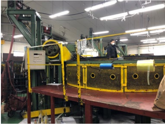
図3-9 無結節網地の編網機と編網されたリサイクル無結節網地
