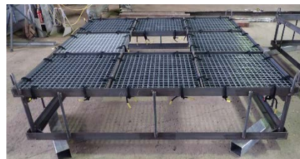
天然岩盤と比較して、着床率・生残率を高める着床育成基盤の開発
