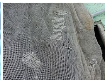
図8. クロサバフグに噛み切られた後、修繕した船曳網の袋網のモジ網部
