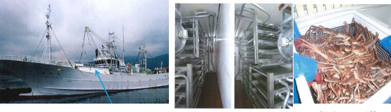
沖合底びき網漁船（ハードオーニング付き） 船内冷凍魚倉 冷却設備
