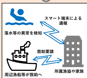
(図5) 落水通報システム
