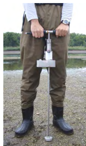
図 3-1-9 貫入式土壤硬度計による地盤硬さの測定
