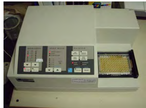
図 3-1-17 フェノール硫酸法によるグリコーゲン測定法 糖質をオレンジ色に発色させ、490nmにおける吸光度を測定する。
