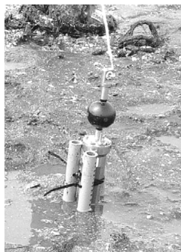
図3-1-14 流速計の設置状態
