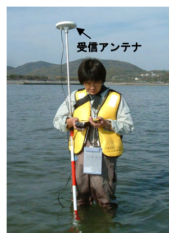
図 3-1-11 GPS を用いた干潟地盤高測定システム (兵庫県水産技術センター提供)
