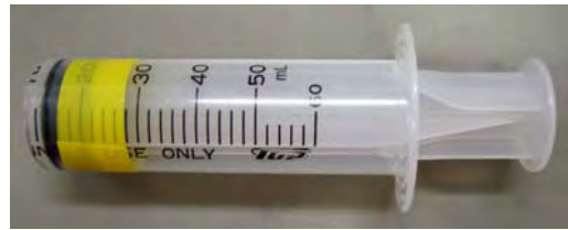
図 3-1-20 コアサンプラ 注射筒の先を切り落としたコアサンプラを利用すると安価で便利である。底質の表面 1cm を採集する研究例が多い。
