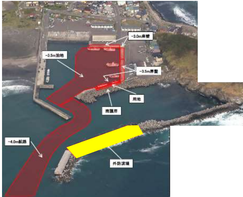
水産流通基盤整備事業 E地区 事業概要図(便益算定対象施設を黄で着色)
