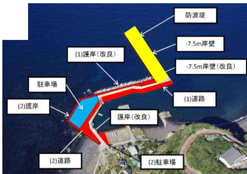
水産流通基盤整備事業 K地区 事業概要図(便益算定対象施設を黄で着色)
