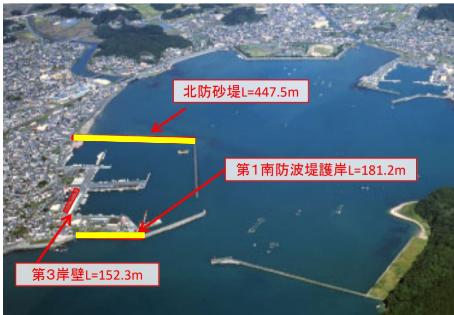
水産流通基盤整備事業 F地区 事業概要図 (便益算定対象施設を黄で着色)
