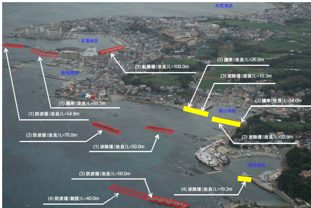
水産流通基盤整備事業 B地区 事業概要図(便益算定対象施設を黄で着色)
