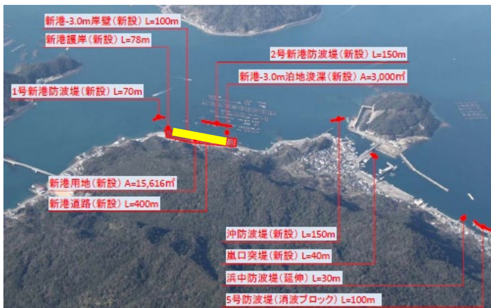
水産流通基盤整備事業 E地区 事業概要図(便益算定対象施設を黄で着色)
