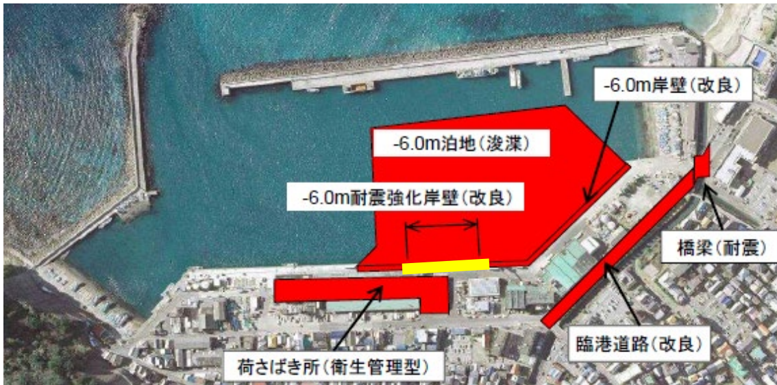
水産流通基盤整備事業 L地区 事業概要図(便益算定対象施設を黄で着色)
