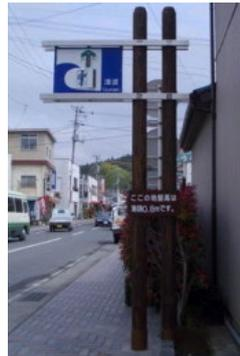
支柱は、杉材(間伐材)を使用大規模な交差点には太陽電池発光により夜間にも対応
