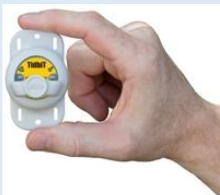
図1 メモリ式水温計（例）
