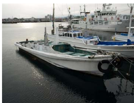
写真 4-6-2 船尾側が沈んでいる船
