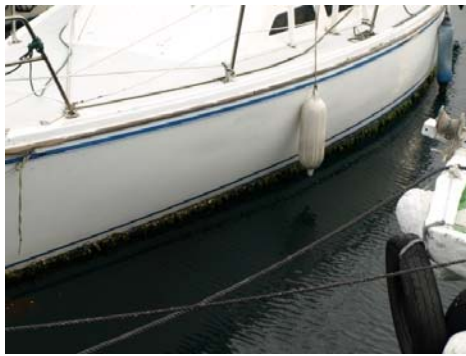
写真 4-6-3 長期間利用されず船底に 藻が付着した船
