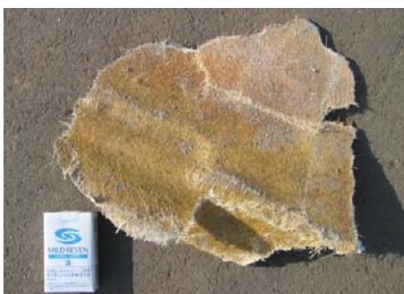
写真 4-5-3 粗破碎されたFRPの断片
