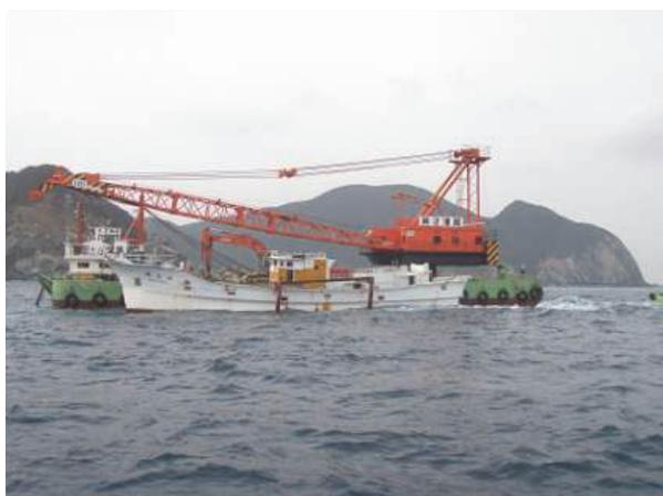
写真-5.9 FRP 沈船魚礁の曳航状況
