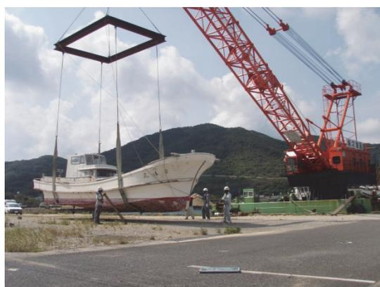
写真-5.3 FRP 漁船の製作ヤード陸揚げ状況
