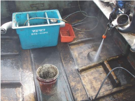
写真-5.4 洗浄状況(油処理剤散布)
