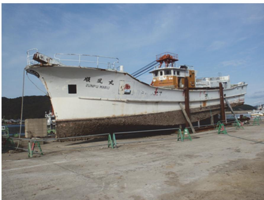
写真-4.2 FRP 沈船魚礁(順風丸)
