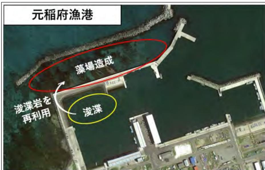
図 1-3 防波堤に藻場造成機能を付加した整備事例<sup>1,2)</sup>
