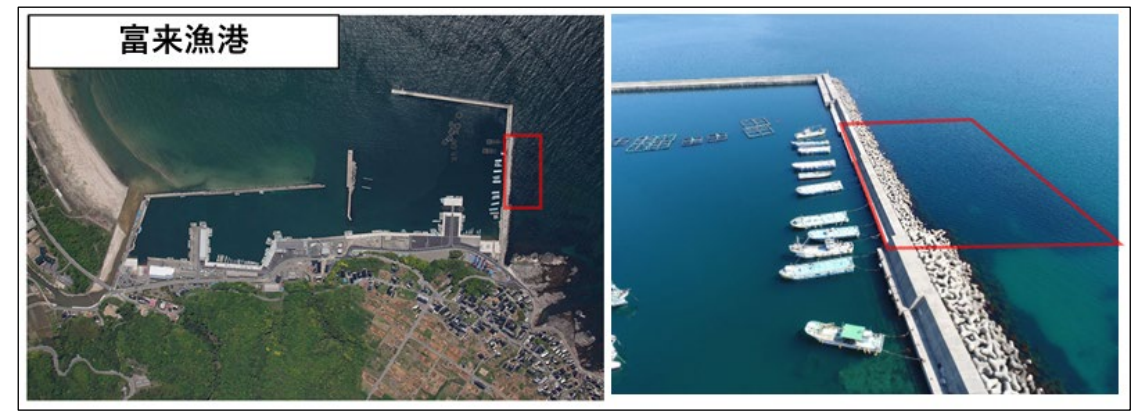
防波堤に藻場造成機能を付加した事例
