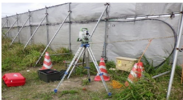
一定時間毎に既設鋼矢板に設置したプリズムへの自動計測
