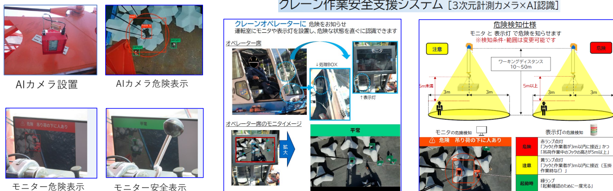
クレーン作業安全支援システム [3次元計測カメラ×AI認識]
