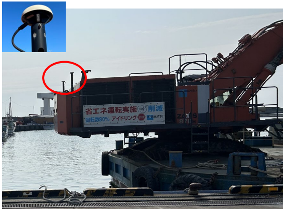
バックホウに搭載したGNSS
