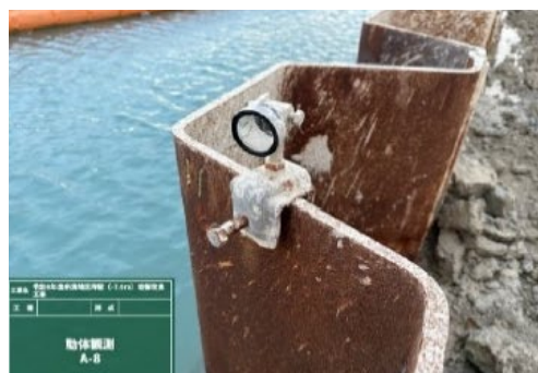
一定時間毎に既設鋼矢板に設置したプリズムへの自動計測
