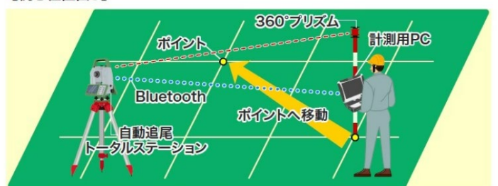
【杭芯位置出し】
