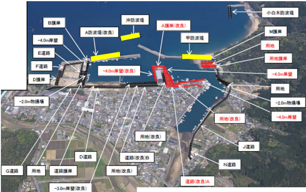
水産流通基盤整備事業 C地区 事業概要図(便益算定対象施設を黄で着色)
