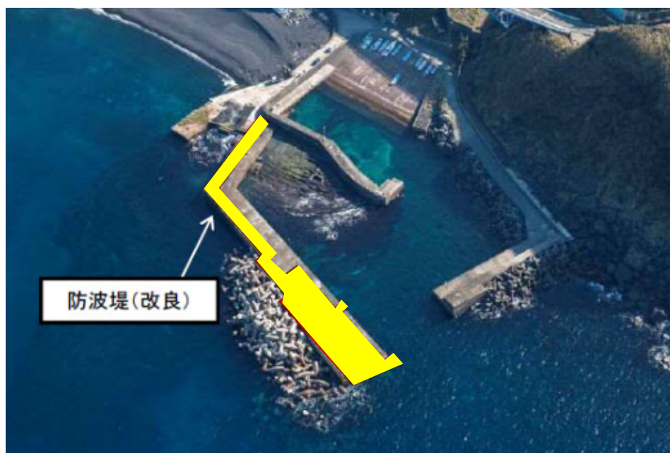
水産流通基盤整備事業 G 地区 事業概要図(便益算定対象施設を黄で着色)
