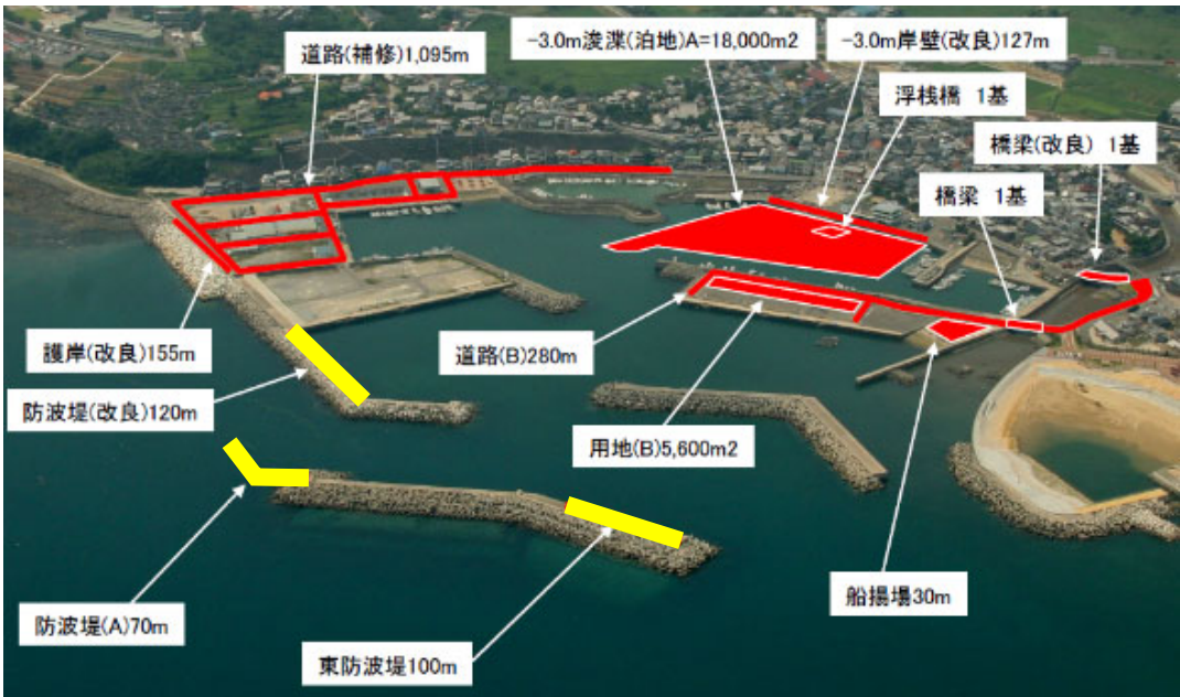
水産流通基盤整備事業Ⅰ地区 事業概要図(便益算定対象施設を黄で着色)
