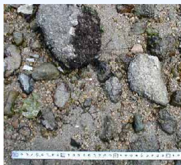
礫の散布による底質の固定
