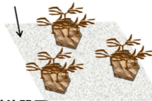
单体設置 (砂による攪乱により大型海藻の繁茂が期待できる)
