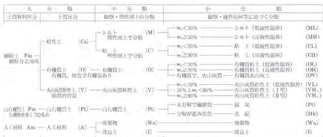
(b) 主に細粒土の工学的分類体系
