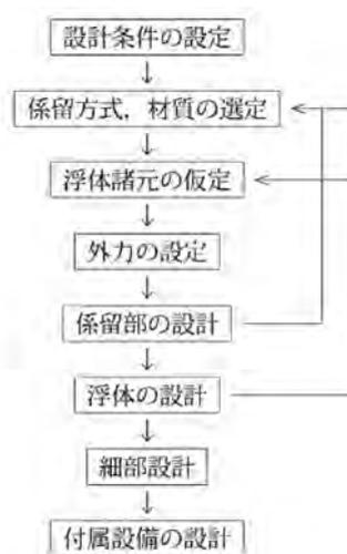
図 5-2-42 浮防波堤の設計フロー
