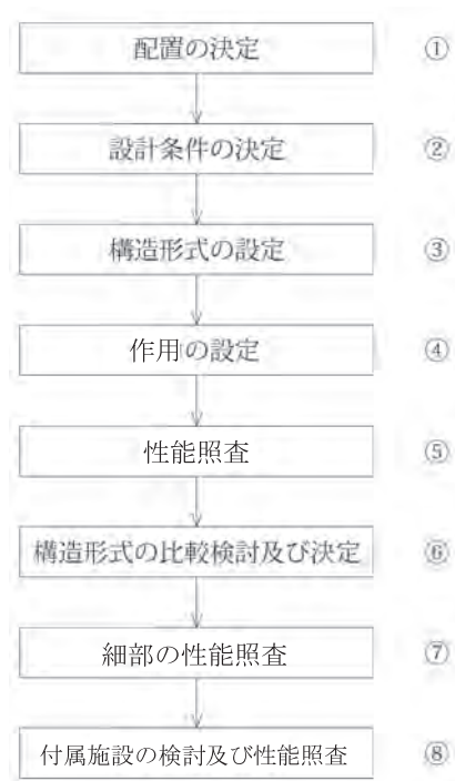
図 6-1-2 係留施設の性能照査フロー
