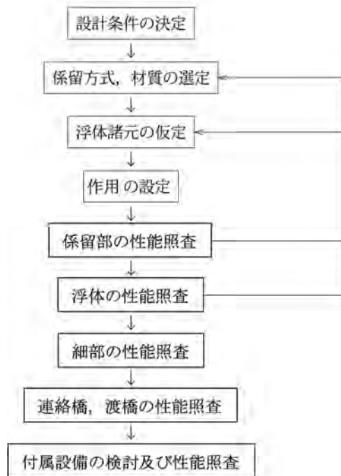
図 6-6-1 浮棧橋の性能照査フロー
