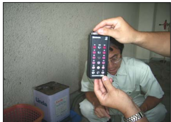
写真 - 1 比色法による残留塩素
