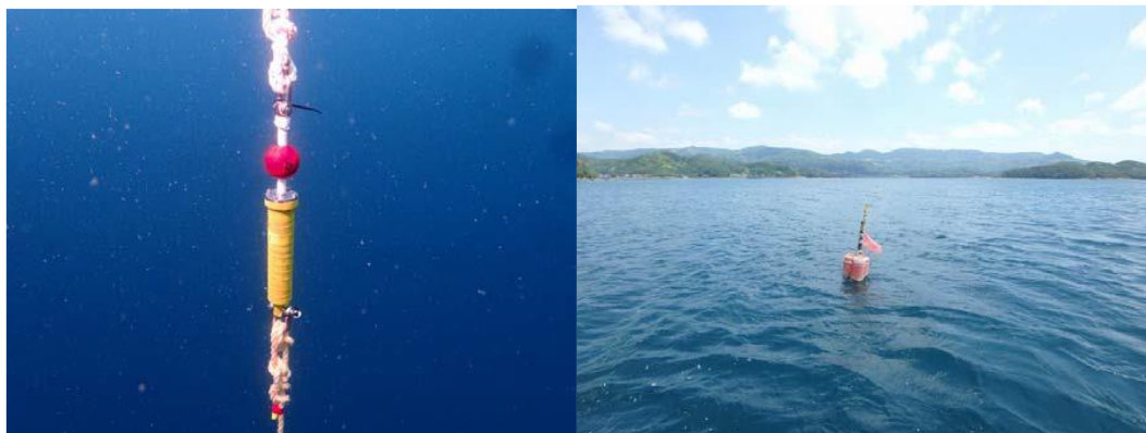
図 4-2-2 電磁流速計の設置状況
