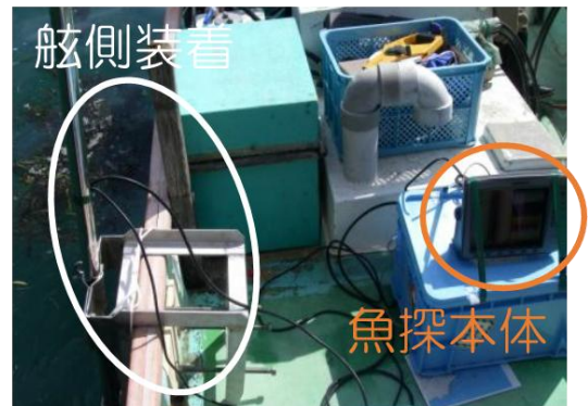
図 5-(3)-1. 魚探の船上での設置の様子
