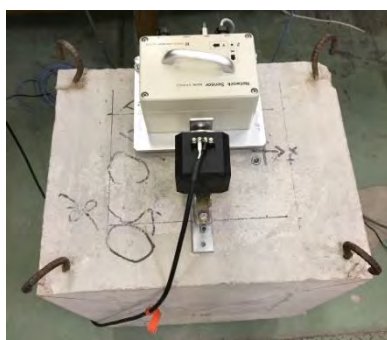
図 d-1-3-3 起振機設置状況（左）と起振機（右）
