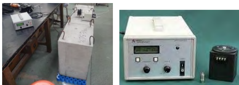
図 d-1-3-7 強制振動測定状況（左）と起振機（右）
