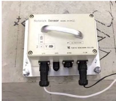
図 d-1-3-4 速度計（センサ；左）と強制振動の測定状況（右）
