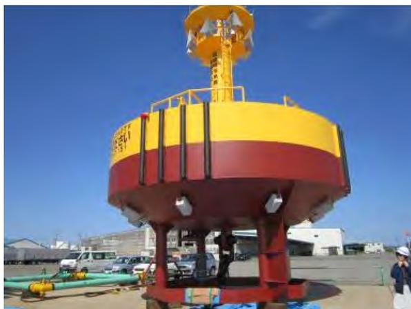
図 6.3 表層型浮魚礁の浮体部（宮崎県のうみさち4号）
