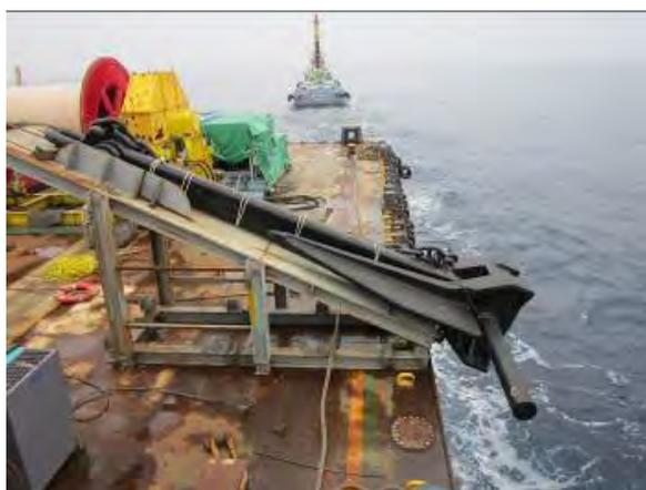
図 6.5 ダンフォースアンカー
