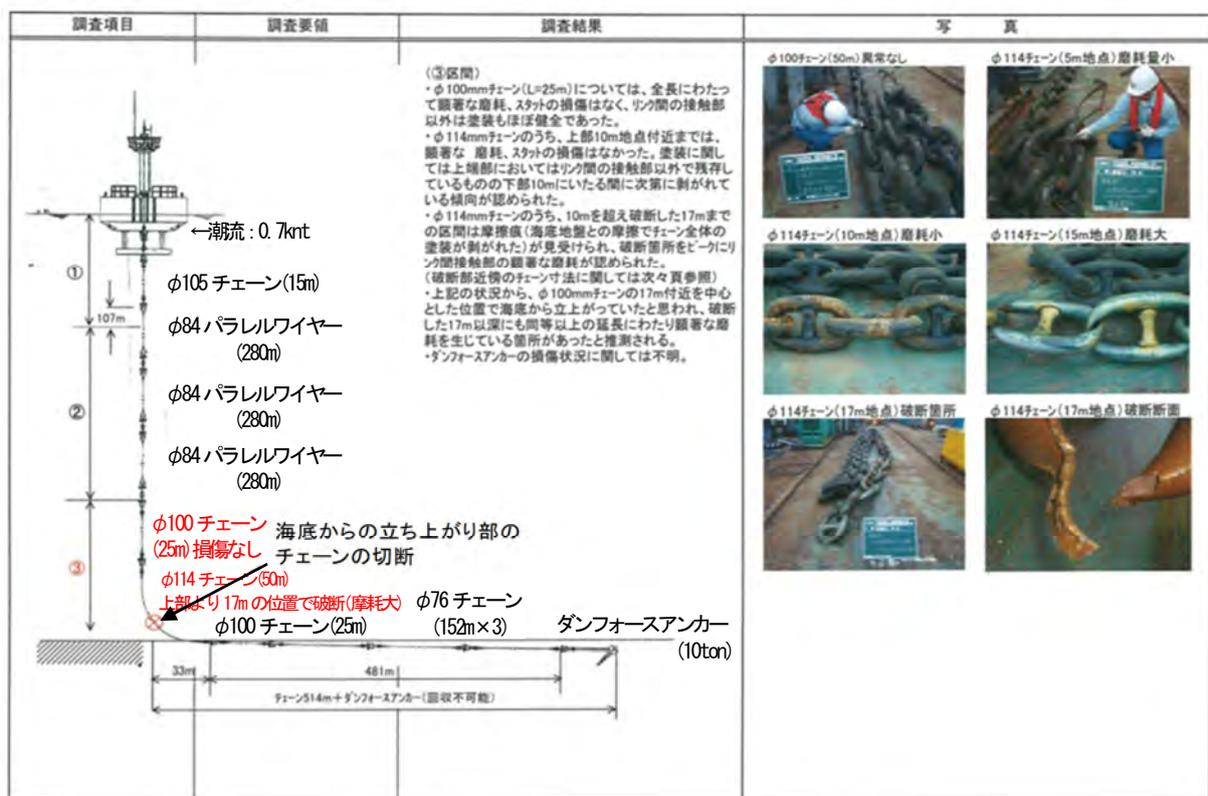
図 6.15 表層型浮魚礁のチェーンの切断事例 (或る県の平成 19 年度調査報告より引用)
