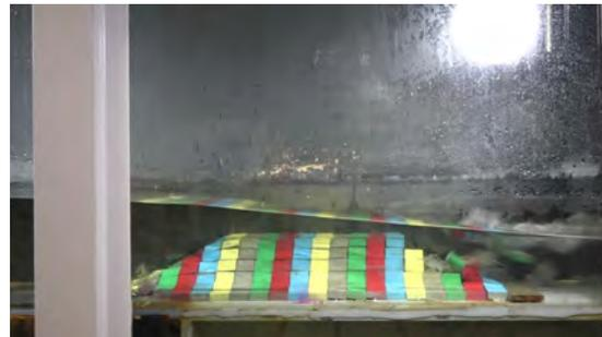
図 3. 7 被覆ブロックの被災状況例 (堤頭部、法勾配 1:1.5、方塊型：小・比重 2.3)
