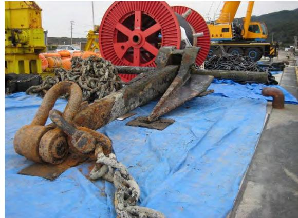
図 6.17 回収後のダンフォースアンカー
