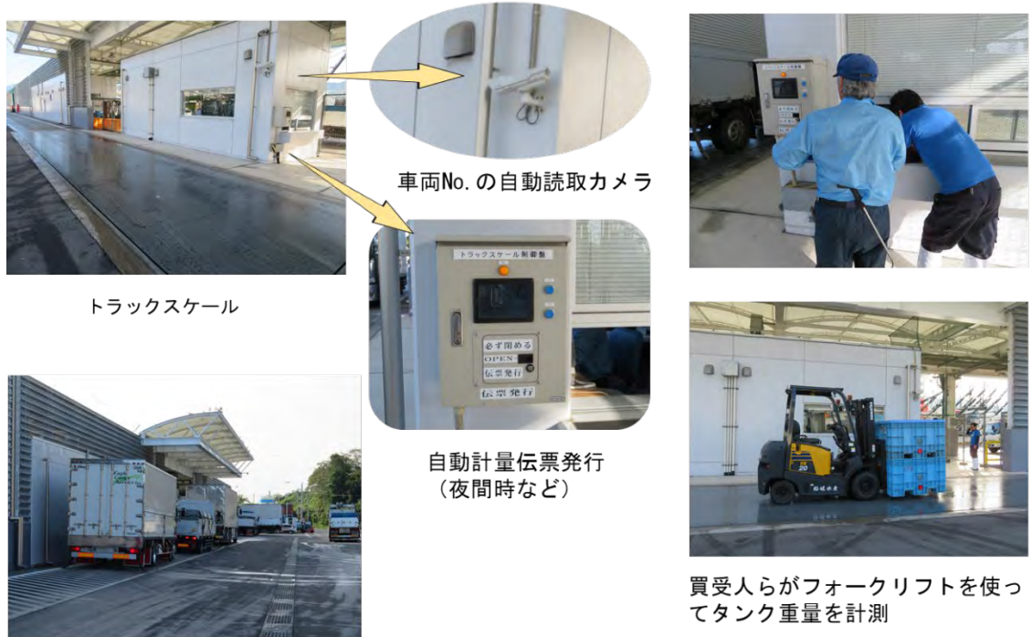
図 2.5.4 トラックスケール自動計量・記録（大船渡市魚市場）
