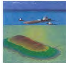
石材投入と海底マウンド建設のイメージ
