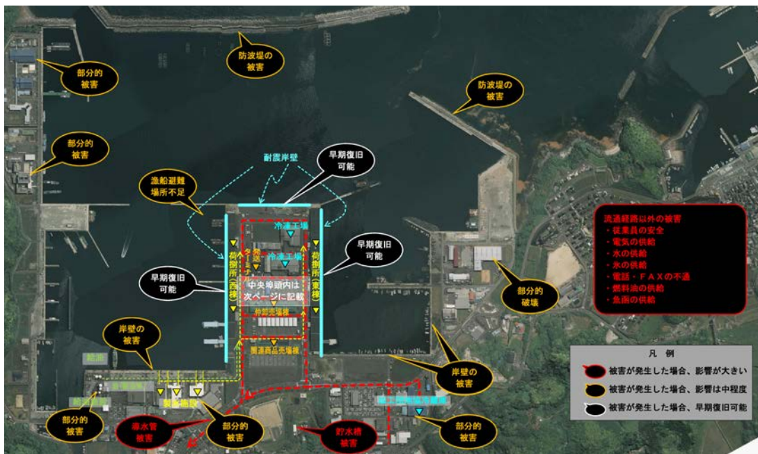
図 1-4 長崎漁港において想定される地震被害
