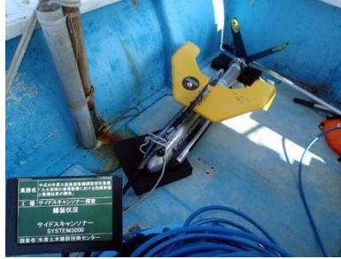
〈 サイドスキャンソナー System3000〉 曳航体(テイルレッサ装着)
