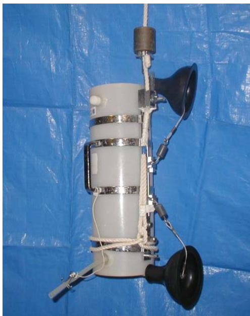
図 e-(2)-29 バンドーン型採水器の仕様
