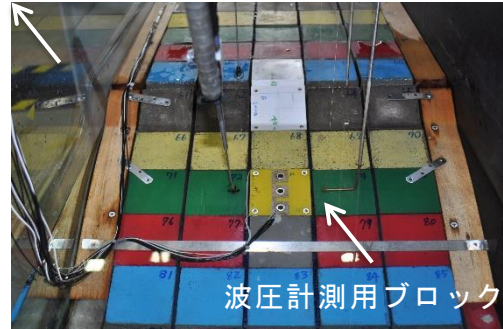
(c) 上流天端+下流法面計測 (下流側から撮影)
