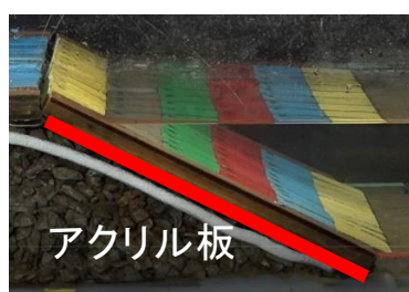
下流側法面のマウンド-ブロック間 （赤線部）に亚克力板を敷設
