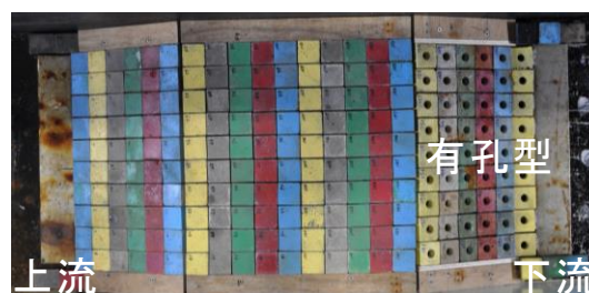
下流側法面のみ小ブロック（有孔型）
