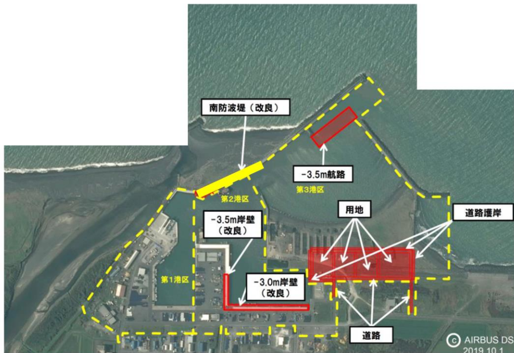
水産流通基盤整備事業 E 地区 事業概要図(便益算定対象施設を黄で着色)
