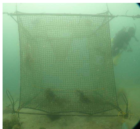
図 - d - イ（ア） - 4 改良型トラップの模式図と設置時の写真。スチール製のフレームがあるものとないものをそれぞれ使用した。
