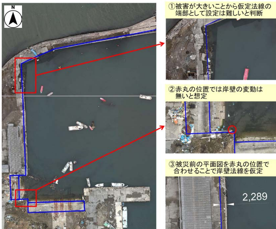
図 1-2-2-3 岸壁法線を仮定する方法での水平変位量の推定(鵜飼漁港)
