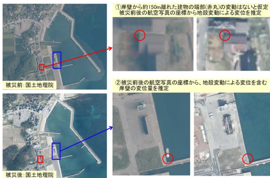
図 1-2-2-5 地殻変動量を推定する方法での水平変位量の推定(狼煙漁港)
