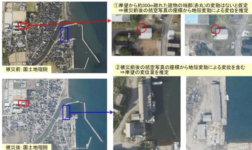
図 1-2-2-6 地殻変動量を推定する方法での水平変位量の推定(鵜飼漁港)
