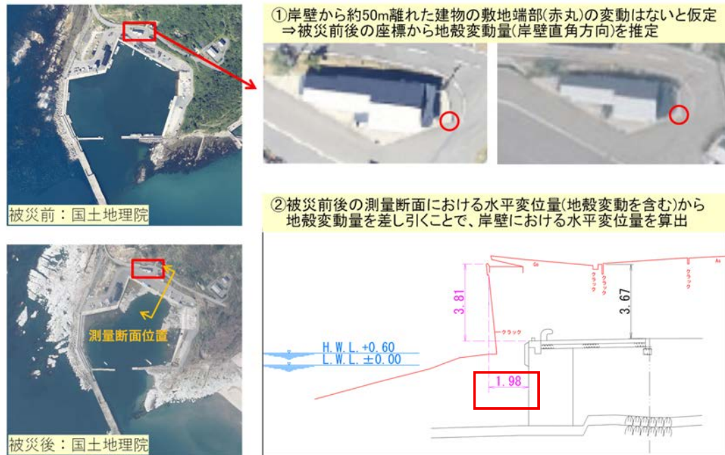
図 1-2-2-7 地殻変動量を推定する方法での水平変位量の推定(鹿磯漁港)
