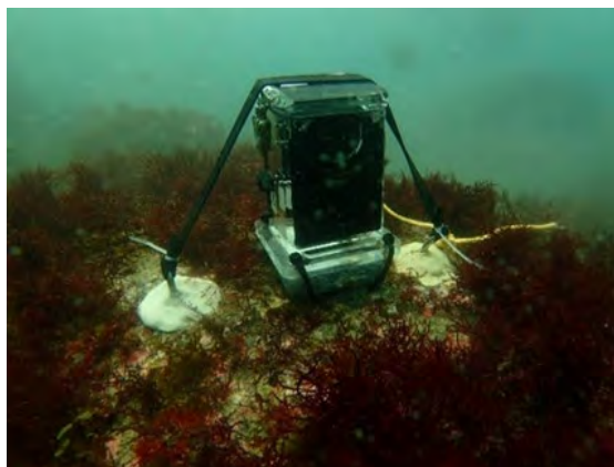
図 7-B2-8 タイムラプスカメラの固定
