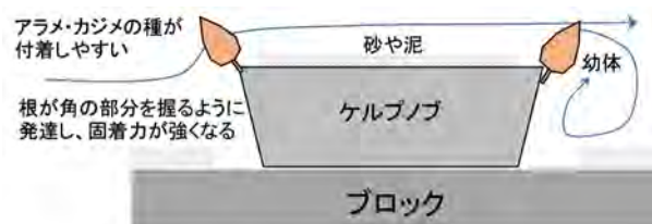
図 7-D6-1 浮泥を払拭しアラメやカジメの着生を促進する逆台形形状「ケルプノブ」
