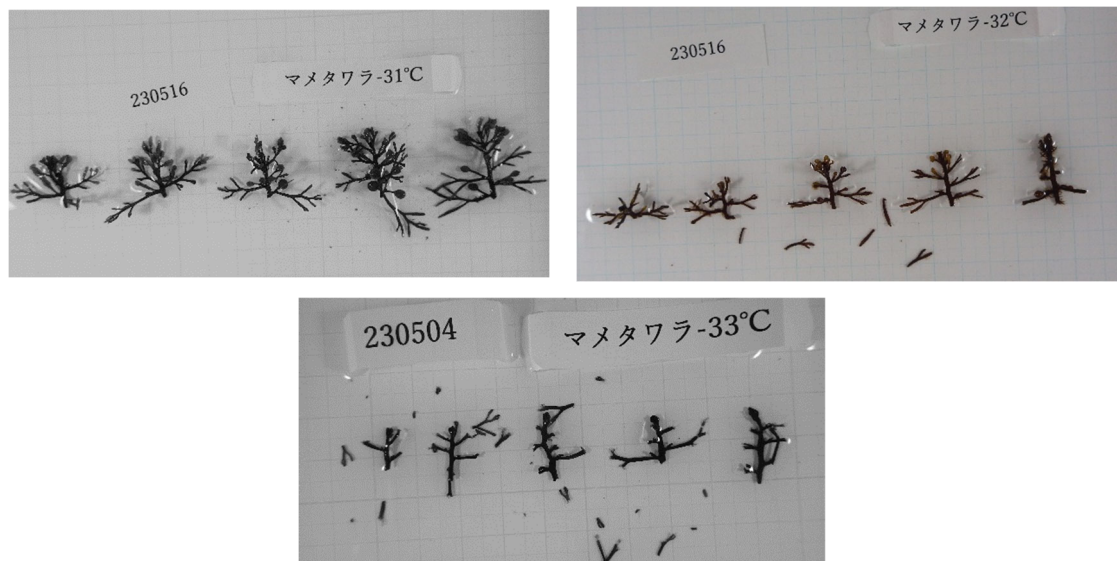
図 1-1 マメタワラにおける室内実験の結果 (上段左 31°C・培養 15 日目、上段右 32°C・培養 15 日目、下段 33°C・培養 3 日目) 33°Cでは藻体が黒化し崩壊している
