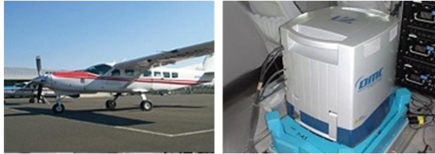
図 3-(4)-1. 測量用の航空機と Digital mapping camera (国際航業株式会社運営解説サイト MoGIST より)
