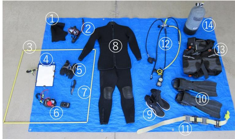
図4-(1)-1. 潜水調査に必要な機材
