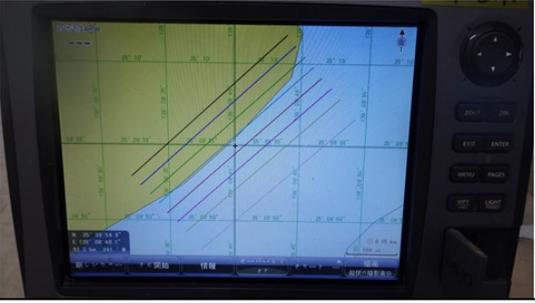
図1. カシミール3Dによる調査ラインの設定と魚探への取り込み
