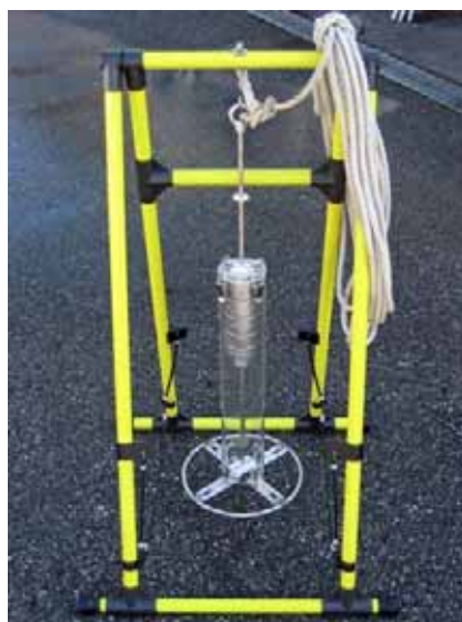
図 1 湖底硬度調査用に製作した湖底貫入計 2
