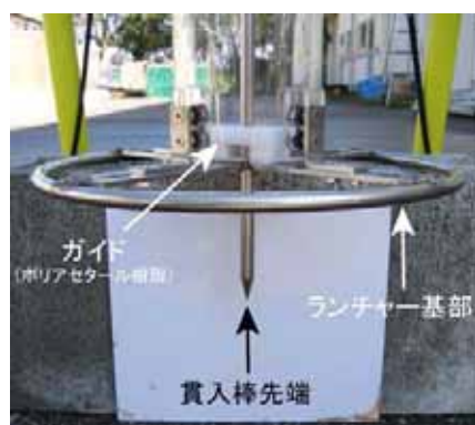
図 2 湖底貫入計 2 (湖底硬度用) の貫入棒とランチャーの接触部分
