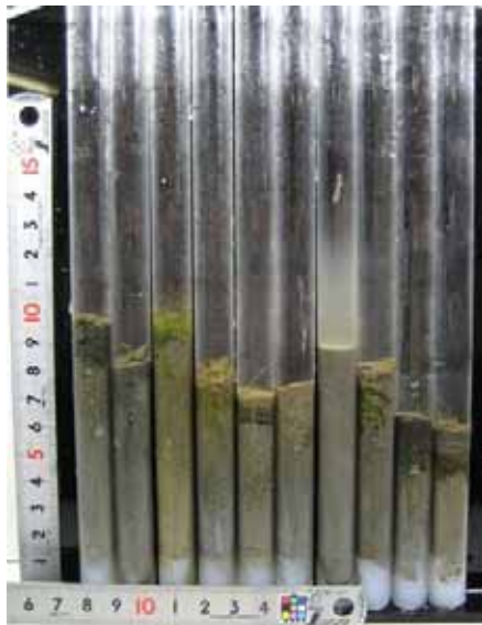
図3 数十メートル間隔で連続的に採取したコアサンプルの例
